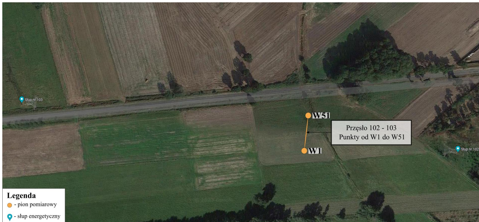
Rys. 23. Lokalizacja pionów pomiarowych od nr W1 do nr W51 – przęsło nr 102 – 103.
