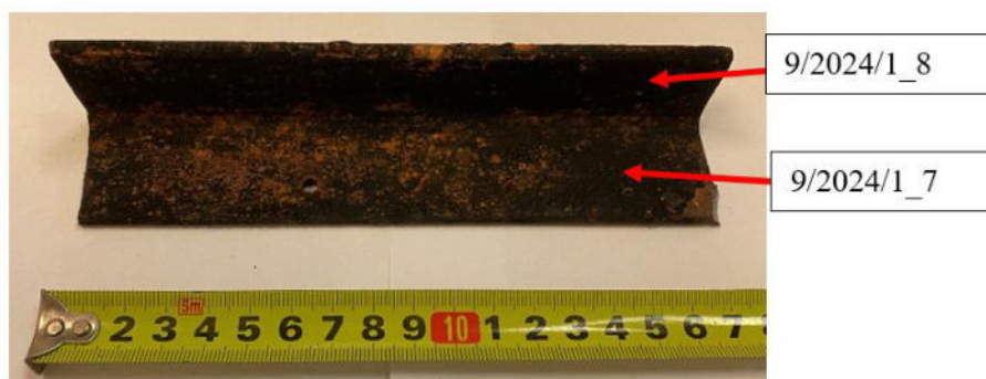
Rys. 7. Zdjęcie próbki 9/2024/1 z oznaczonymi obszarami pomiarowymi.
