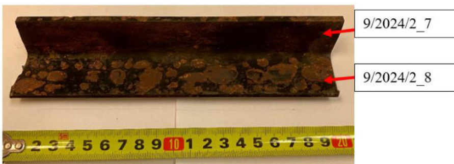
Rys. 8. Zdjęcie próbki 9/2024/2 z oznaczonymi obszarami pomiarowymi.
