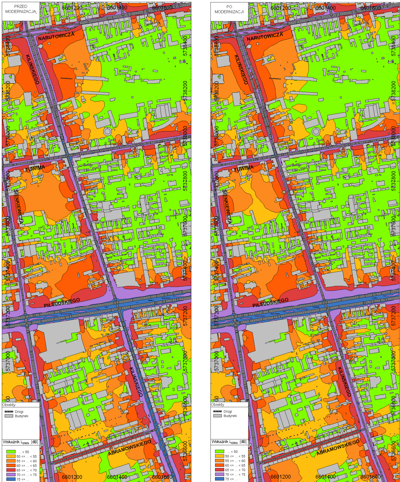
Rys. 12. Efekty modernizacji nawierzchni drogowej. Zasięg hałasu – dla wskaźnika L_{DWN} – odcinek ulicy Kilińskiego
